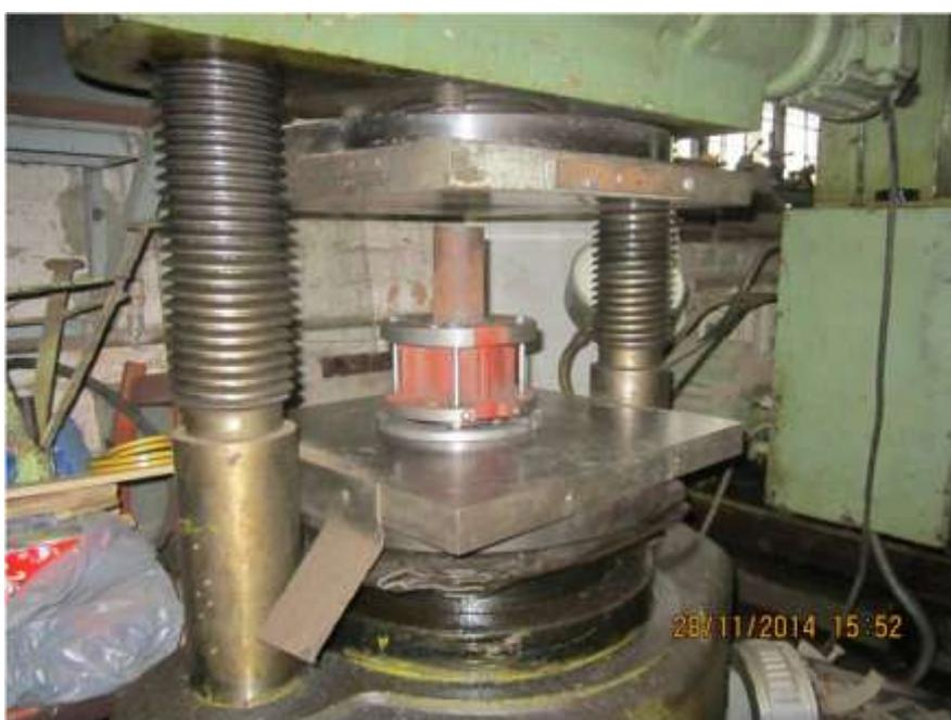
Рис. 2. Установка для получения масла из семян табака методом прямого отжима
