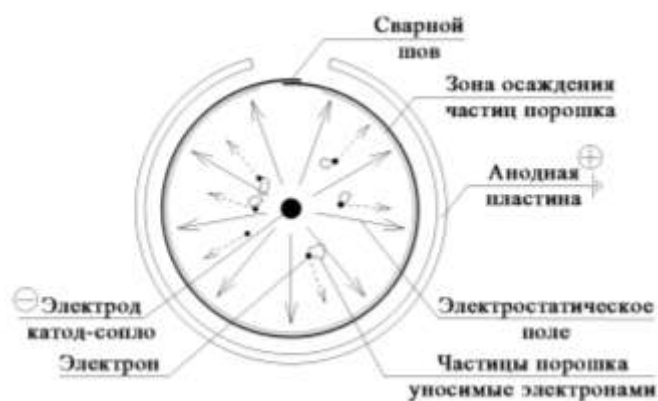
Рис. 2. Схема нанесения порошкового лака на внутреннюю поверхность корпуса банки
