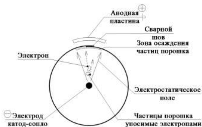
Рис. 1. Схема нанесения порошкового лака на внутреннюю поверхность банки в зоне сварного шва
