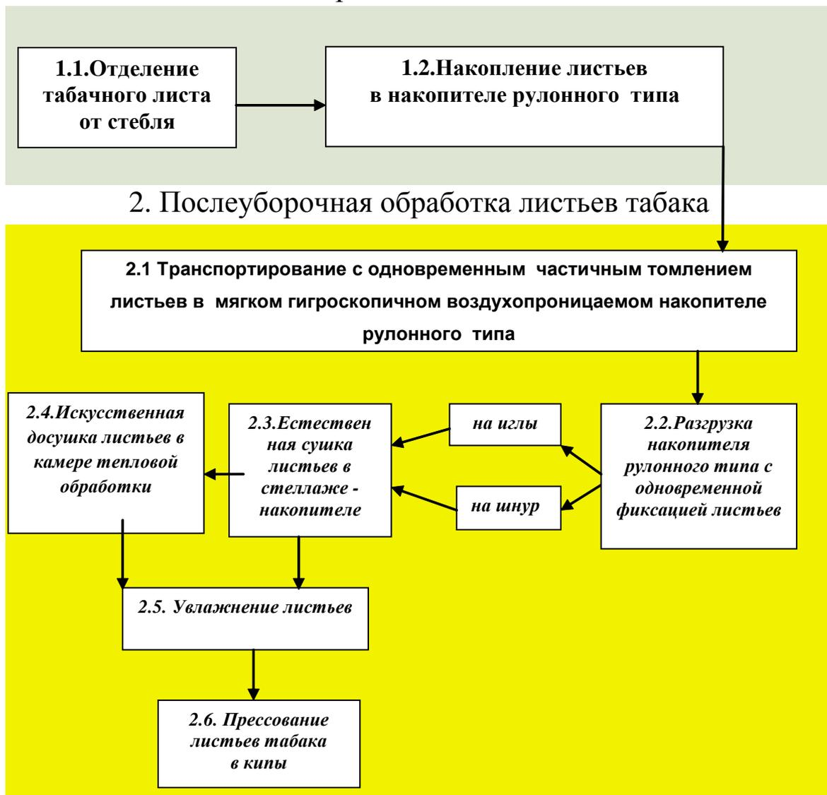
Рис. 1. Схема технологии ручной уборки и послеуборочной обработки в едином потоке
