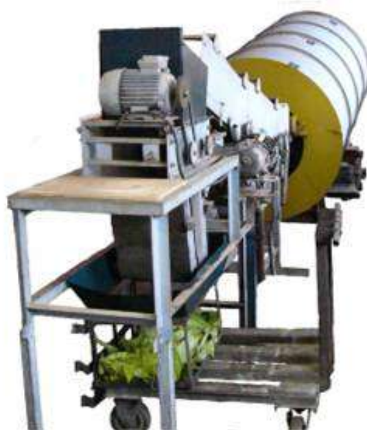
Рис. 2. Экспериментальный образец линии для подготовки листьев табака к сушке
