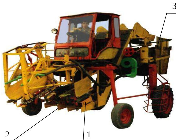
1 – технологический контейнер; 2 – узел сепарации; 3 - бункер
