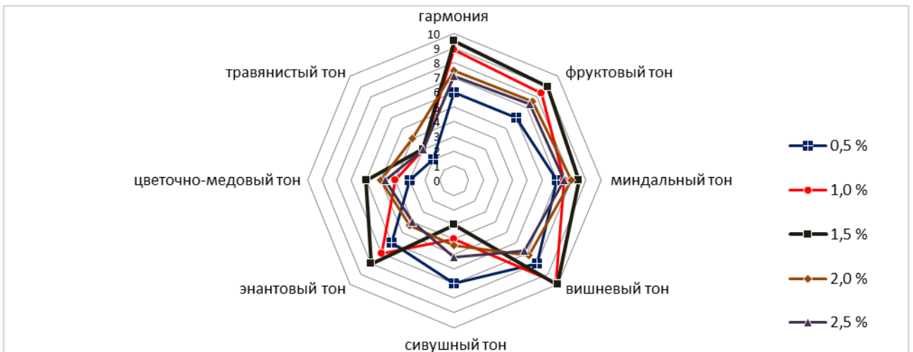
Рис. 4. Сенсорный профиль аромата вишневых дистиллятов, полученных при различном объеме отбора головной фракции
