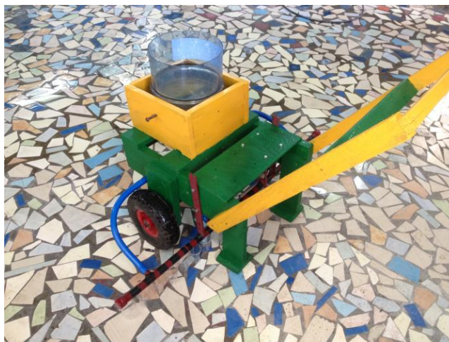
Рис.1. Макетный образец сеялки для гидравлического посева семян табака в парниках
