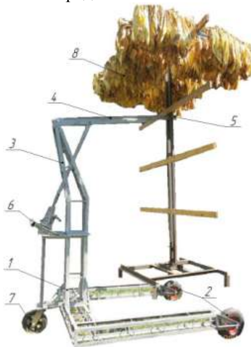
1 – тележка, 2 – колеса, 3 – подъемник, 4 – стрела, 5 – крюк, 6 – гидравлический домкрат, 7 – поворотное колесо, 8 – вешалка с табаком, Рис. 5. Погрузчик, удерживающий вешалку с табаком
