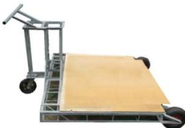
Рис. 6. Тележка (нижняя часть погрузчика после разборки)
