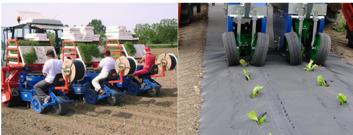
Рис. 2. Машина для посадки рассады типа ФРА
