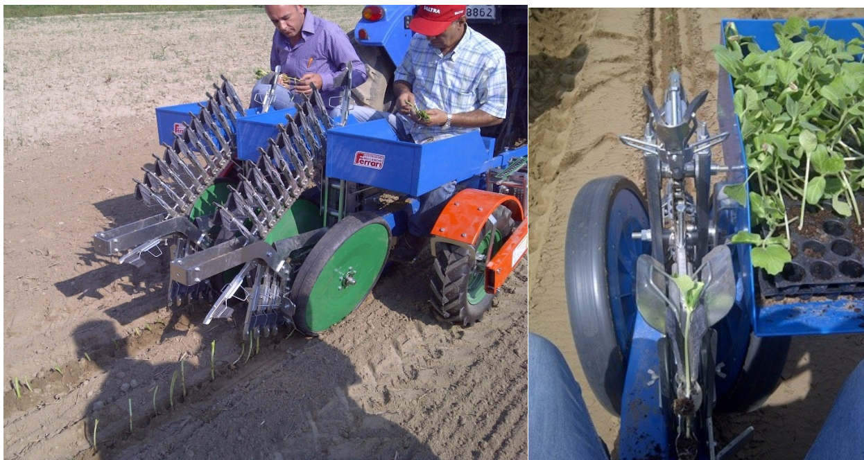
Рис. 3. Машина для посадки рассады типа FPS/ FPP
