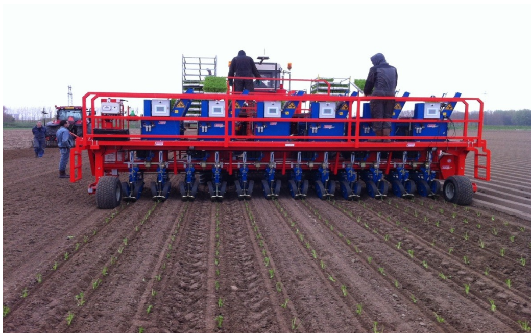
Рис. 6. Рассадопосадочный автомат типа FUTURA
