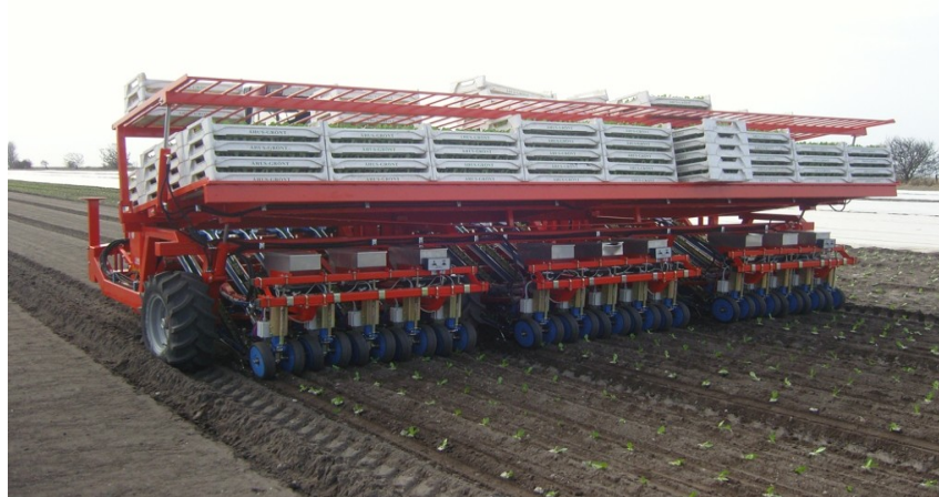
Рис. 4. Машина для посадки рассады типа ROTOSTRAPP
