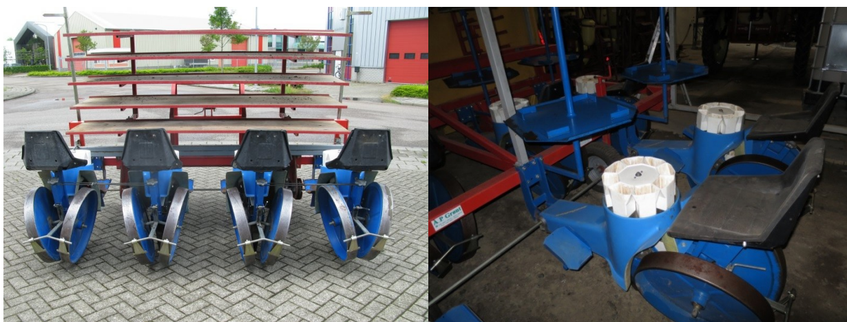
Рис. 5. Машина для посадки рассады типа FMAX
