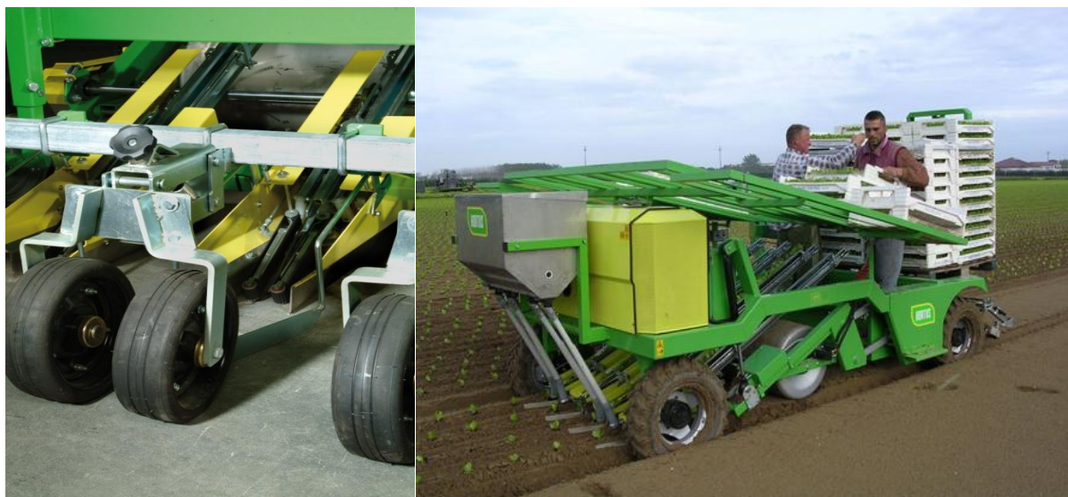
Рис. 3. Автоматическая машина для высадки рассады из кассет с ячейками типа TRE – TRE MATIC
