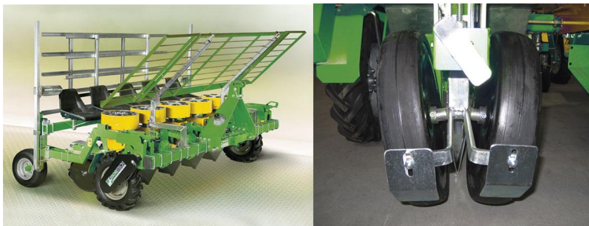
Рис. 5. Рассадопосадочная машина для высадки рассады из кассет с ячейками конусной или пирамидальной формы
