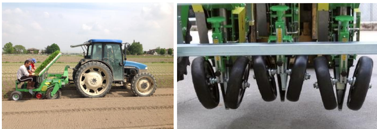
Рис. 6. Рассадопосадочная машина марки PRACTICA MIDI
