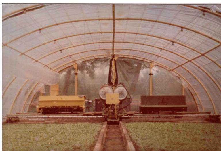
Рис. 2. Мостовое электрифицированное шасси с комплексом технических средств для выращивания рассады табака
