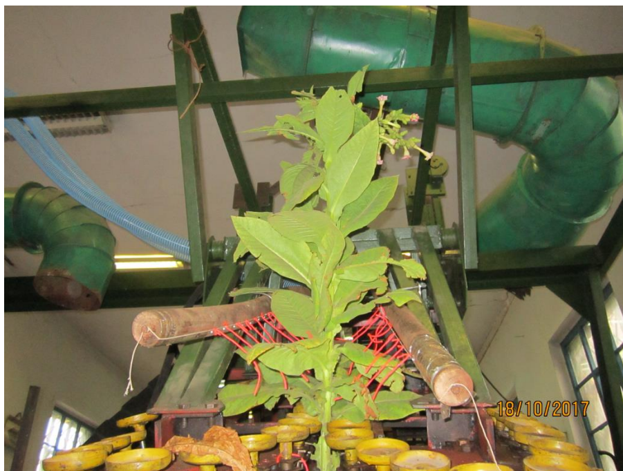
Рисунок 6. Аэродинамическая картина воздействия пневматической системы на процесс отделения листьев табака
