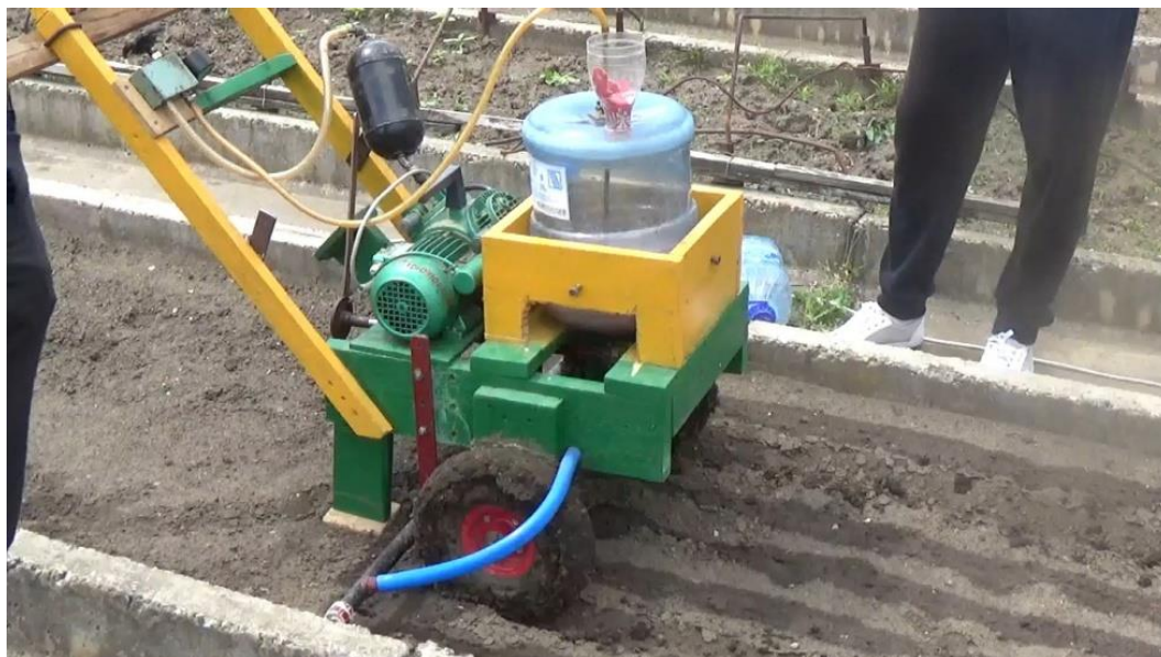
Рисунок 3. Общий вид экспериментального образца сеялки для рядкового посева семян гидравлическим способом
