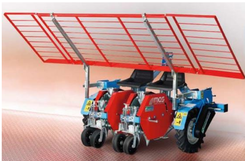
Рисунок 5. Рассадопосадочная машина «OVER» для работы на замульчированной пленкой почве
