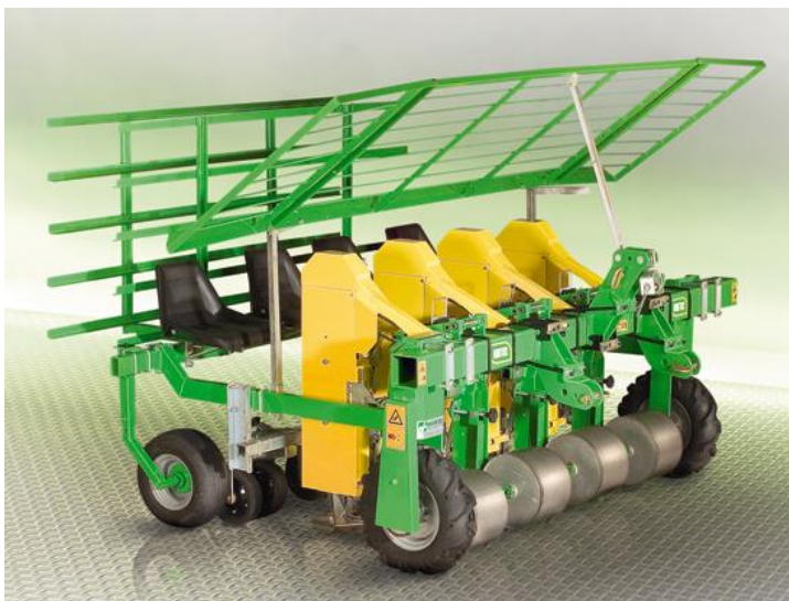
Рисунок 3. Рассадопосадочная машина «EASY» для открытого грунта
