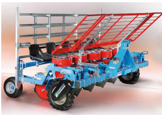
Рисунок 6. Пятирядная машина «PRACTICA» для высадки рассады
