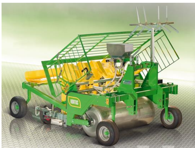
Рисунок 2. Рассадопосадочная машина «DUE MANUAL» с мульчированием пленкой и укладкой ленты капельного орошения
