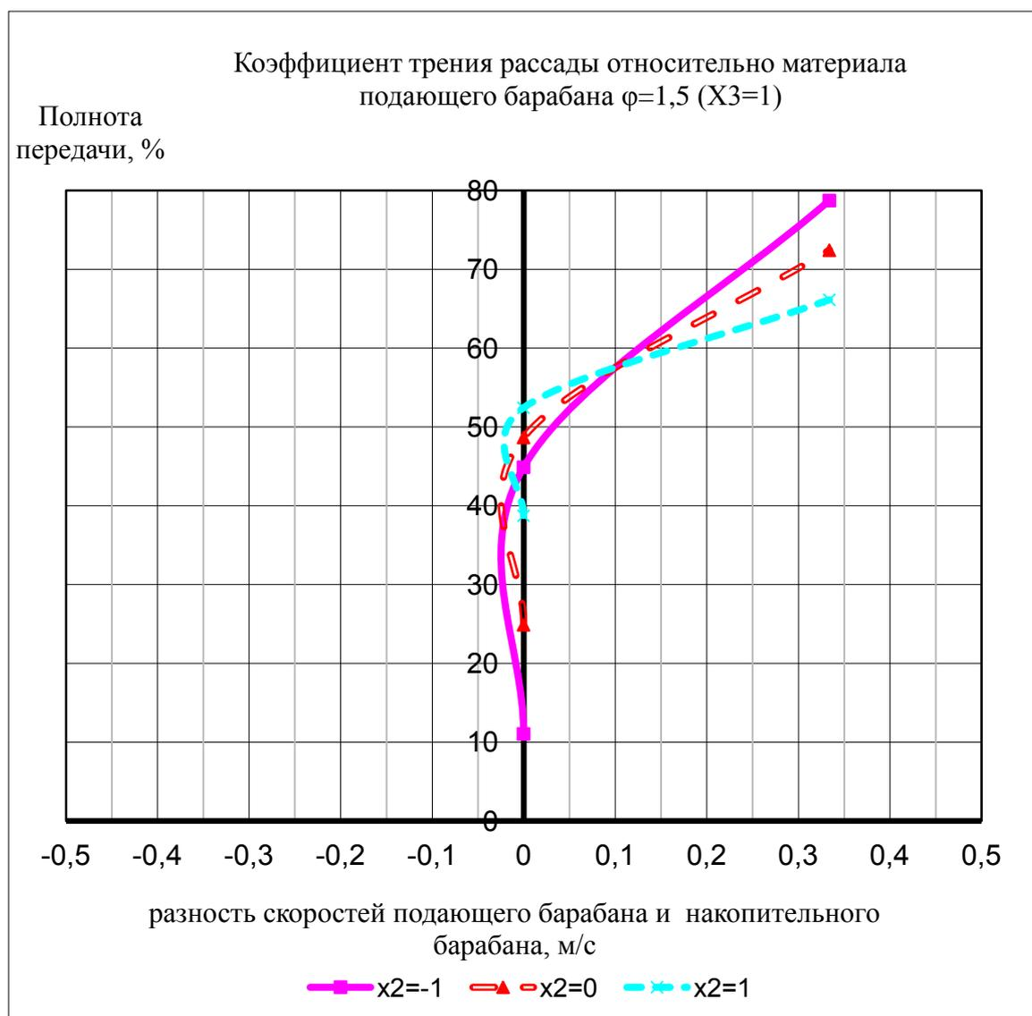
Рисунок 5. Влияние разности скоростей барабанов  $X_1$  и коэффициента трения накопительного барабана  $X_2$  на полноту передачи рассады от накопительного к подающему барабану (при коэффициент трения рассады относительно материала подающего барабана  $\varphi=1,5$  ( $X_3=1$ ))
