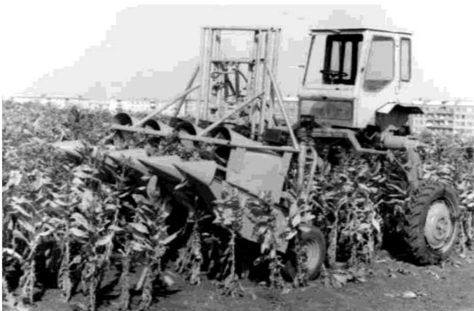
Рисунок 5. Общий вид машины для обмолота соцветий табака на корню в 4-х рядной варианте
