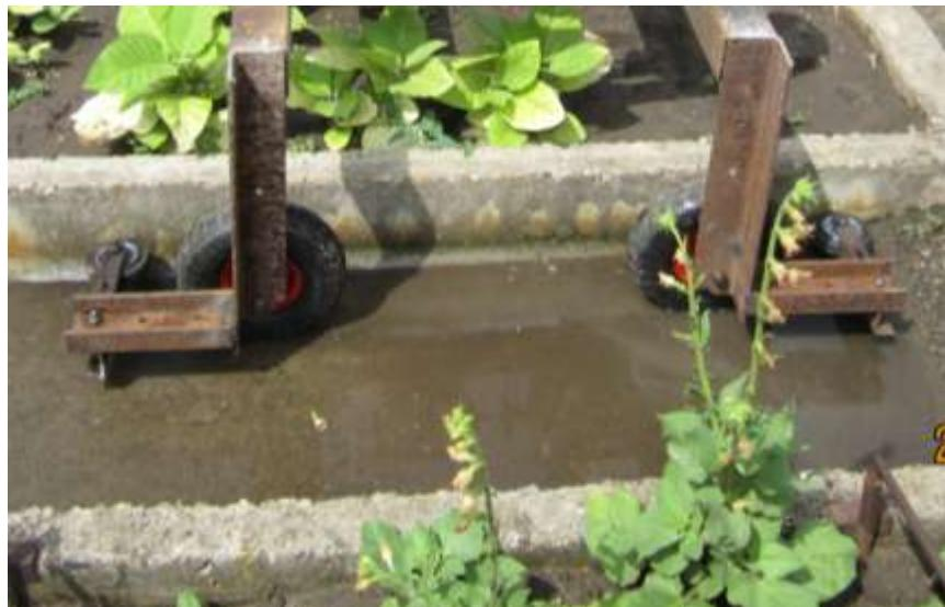
Рисунок 4. Общий вид стабилизирующих колес мостового энергетического средства
