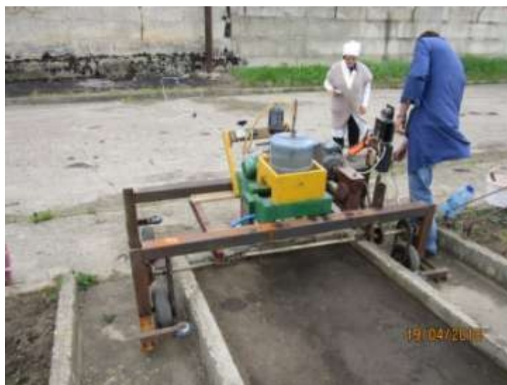
Рисунок 1. Общий вид машинно-тракторного агрегата «мостовое электрифицированное шасси + сеялки для рядкового посева семян табака и овощных культур гидравлическим способом»
