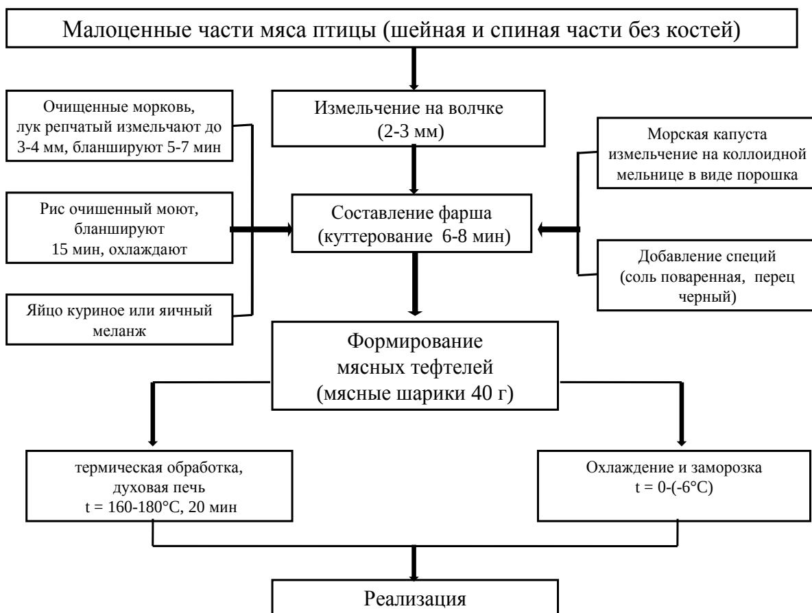
Рисунок. Технологическая схема производства мясных тефтелей
