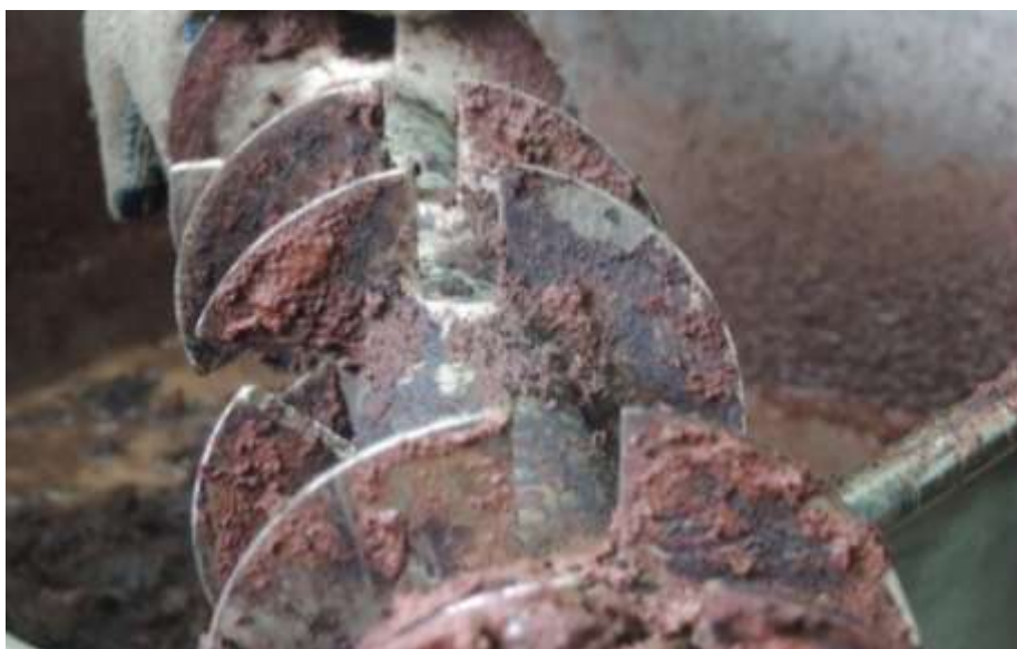
Рисунок 1. Белковый нагар на шнеке из пищевой нержавеющей стали
