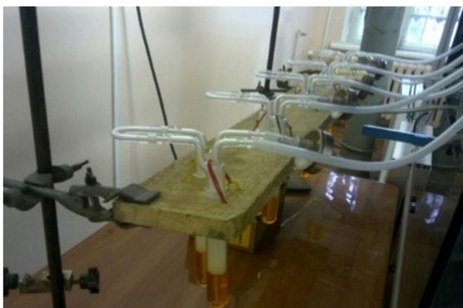
**Рисунок 7.** Улавливание карбонильных соединений с помощью барботеров, присоединенных к курительной машине
