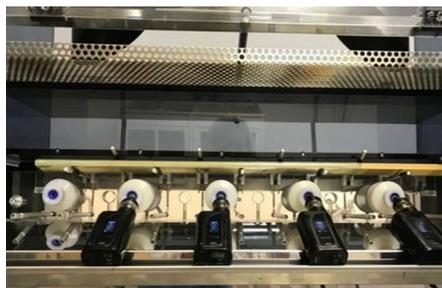
**Рисунок 6.** Генерация аэрозоля жидкостями для ЭСДН на курительной машине
