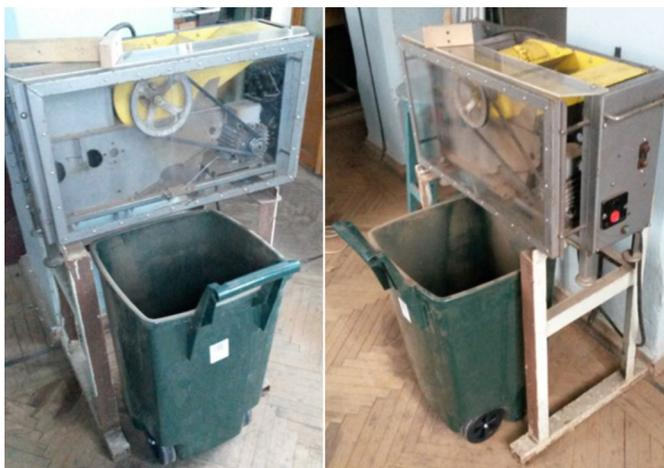
**Рисунок 3.** Экспериментальный образец установки для обмолота соцветий
