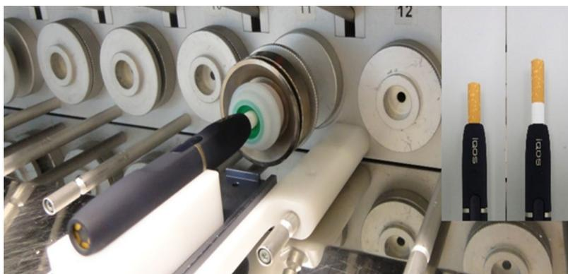
**Рисунок 3.** Сбор аэрозоля изделий из нагреваемого табака на курительной машине Cerulean SM450
